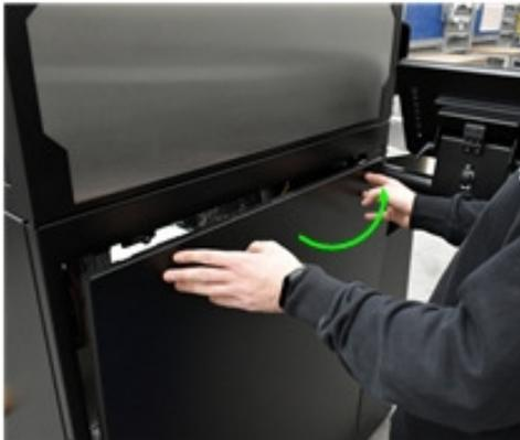
c) 在隨後關閉時，請注意底部的小銷釘。必須將它們精確地插入到烘焙機的孔中。
