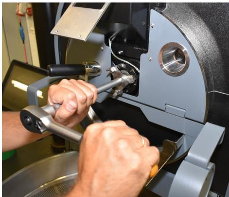
l) 有了可逆棘輪和 $\frac{1}{2}$ 平方英寸的擴展，您現在可以通過逆時針旋轉間隙來減少咖啡的破損。
