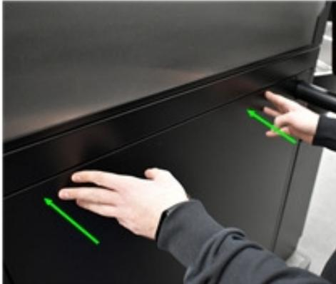
b) 蓋板門鎖鬆開。彈簧機制彈開蓋子。從上方卸下蓋板。
