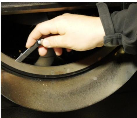
j) 現在可以在出口擋板內部，滾動和外壁之間的塞尺測量間隙。
