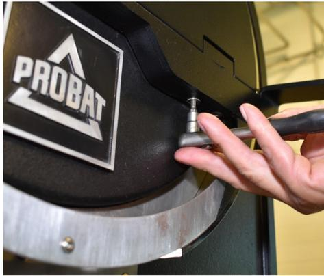
l) 用 4 毫米內六角扳手卸下排空擋板下的四顆螺絲。
