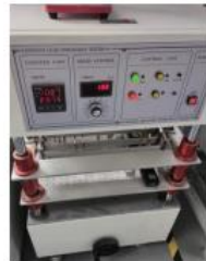
控制台耐久性測試*(1) 操作鍵盤20萬次
